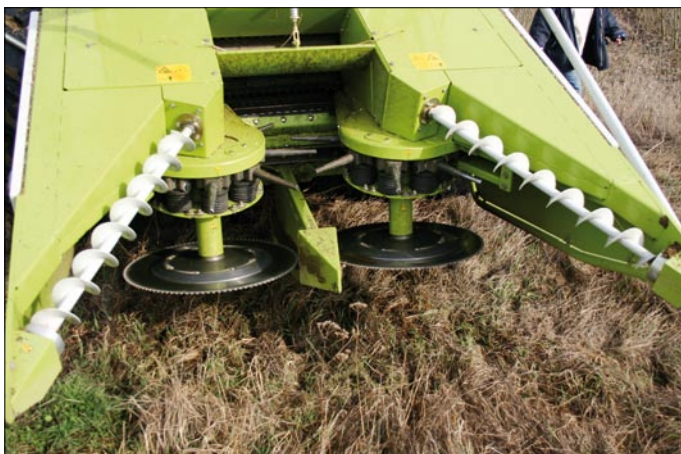
Abb. 3: Holzerntevorsatz HS-2 der Firma Claas; es können Stämme mit einem maximalen Durchmesser von bis zu 70 mm abgetrennt werden.
