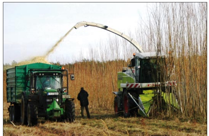
Abb. 4: Vorgeführte Erntetechnik der Firma Claas bei der Beerntung des Weidenbestandes auf der Versuchsfläche in Cahnsdorf
