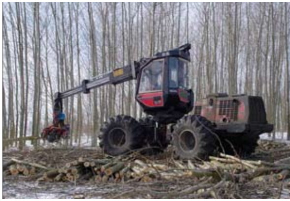
Abb 3 Harvester Valmet 901 bei der Ernte eines 10jährigen Pappelbestandes in Methau (2006). Foto: T. Kienz
