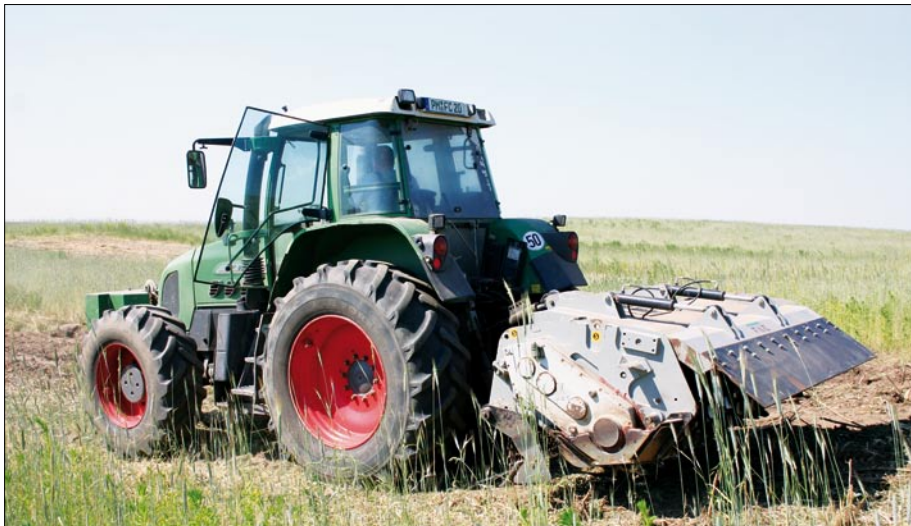
Abb. 1: Rodungsfräse FAE, SSM-225 an einem Fendt Vario 926; Einsatz im Tagebau Jämschwalde
